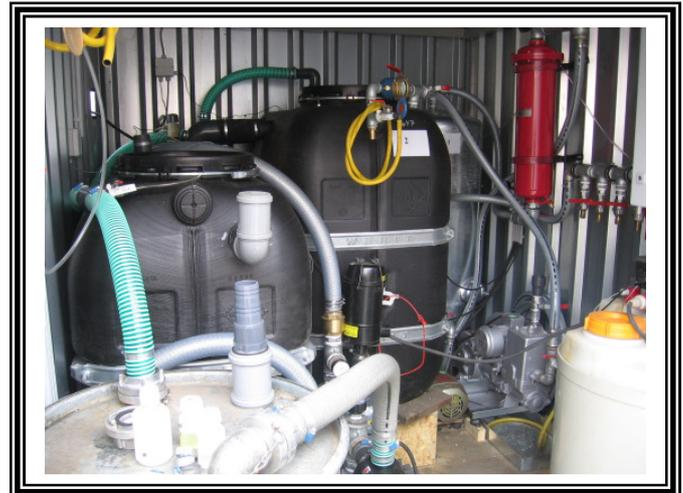
Die Bilder zeigen eine Bodenluftabsaugung in EX-geschützter Bauweise sowie eine Wasseraufbereitung im Einsatz.
